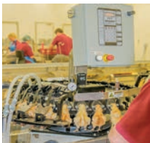
Epointage par la méthode infra-rouge
